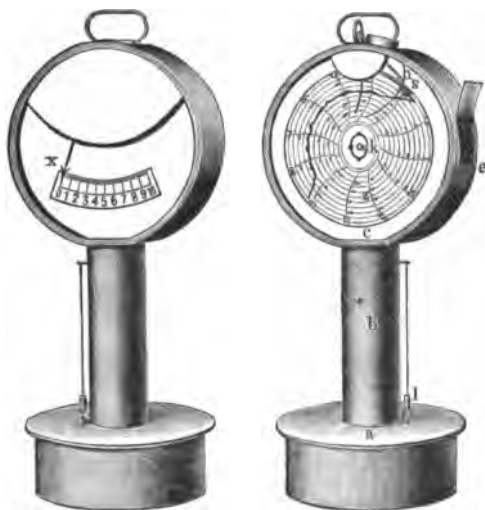
Fig. 80 et 81. — Indicateur de tirage enregistreur d'Obel.
